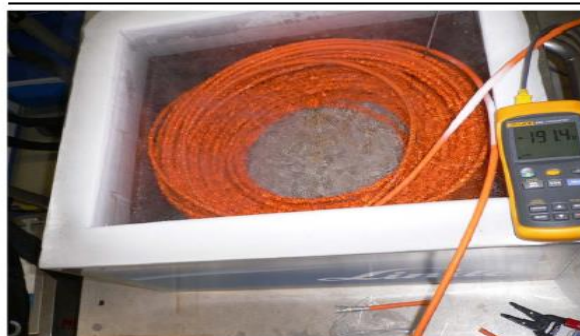
Abb. 3: Kabelring in einer mit flüssigem Stickstoff gefüllten Isolierwanne
