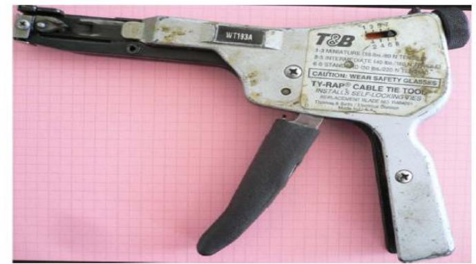
Bild 3: Kabelbinderzange mit einstellbarer Zugkraft (220 N)
