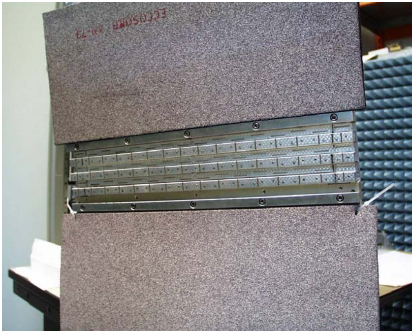
Abb. 15: Messaufbau für ein Subarray bestehend aus drei T/R-Modulen. Die Speisung erfolgte für vertikale Polarisierung.
