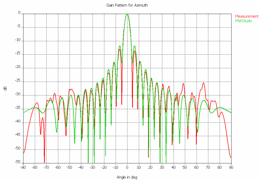
Abb. 20: Vergleich Messung-Rechnung für den azimutalen Schnitt.
